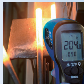
Θερμόμετρο ψηφιακό (laser αποστάσεως) -30 +550 βαθμούς κελσίου 9DN12
