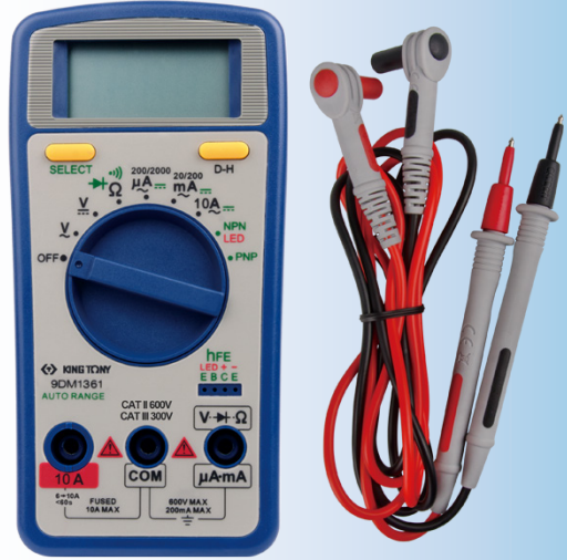
Πολύμετρο ψηφιακό AC/DC 500mA / 660V & 10A / 600V 9DM1361
